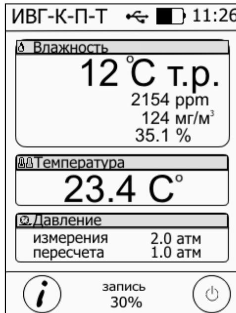
Рисунок 5.1 Режим отображения каналов измерения
